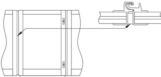
Наклеиваем уплотнитель 8x17 в проём калитки.
