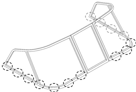
В нижнем профиле рамки есть отверстия, через которые будет осуществляться крепление ветрового стекла к корпусу лодки.
