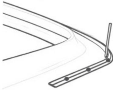
С помощью шила, в местах крепления рамки, делаем отверстия в уплотнителе, чтобы предотвратить налипание на винты клеевой основы уплотнителя.
