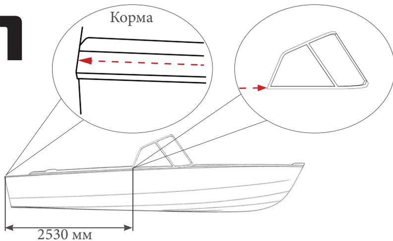
Отметьте контрольные точки для установки боковых элементов рамки. Расстояние от кормы: 2530 мм.
