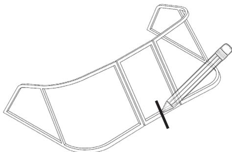
Для дальнейшего, точного, позиционирования ветрового стекла относительно оси симметрии лодки, необходимо отметить центр палубы в районе выхода (калитки).
