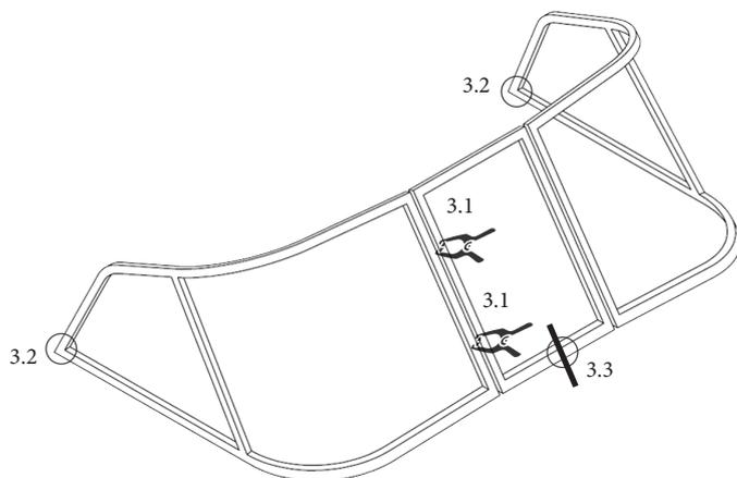
3.1 Зафиксируйте створ калитки при помощи струбцин или зажимов обеспечив зазор 3 мм в притворе.
