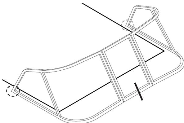
Для точного позиционирования ветрового стекла на лодке необходимо установить боковые элементы на точках отмеченных ранее.
